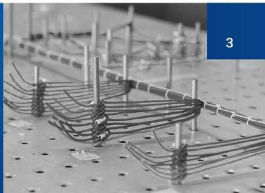
Операция раскладки и вязки, сборки проводов в жгуты на шаблонах выполняется вручную опытными вязальщиками схемных жгутов, кабелей и шнуров не ниже 5 – го разряда.
